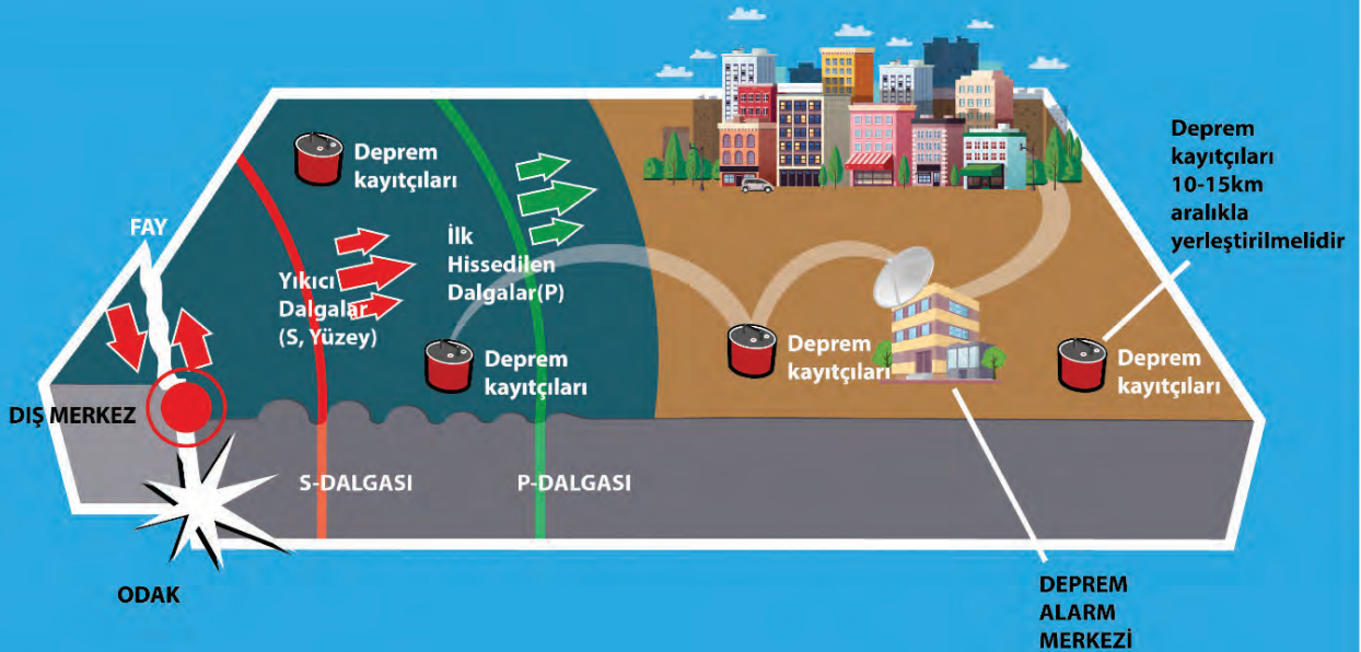
Şekil 5. Deprem erken uyarı sisteminin şematik gösterimi. Deprem iç merkezi odak olarak gösterilmiştir. En hızlı ilerleyen dalgalar ilk dalga (P) olarak, daha düşük hızla ilerleyen ikincil dalgalar (S) ve üçüncül olarak en yavaş dalgalar yüzey dalgası olarak gösterilmiştir (Barış vd, 2022' den alınmıştır).
